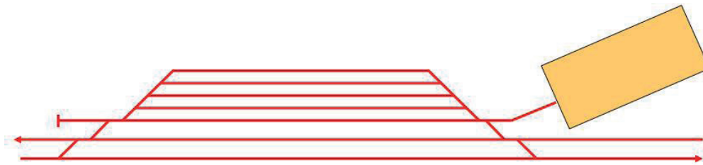
Figur 6. Placering av överlämningsbangård (vänster) i linje med lastspår och terminal (höger) för effektiv växling.
