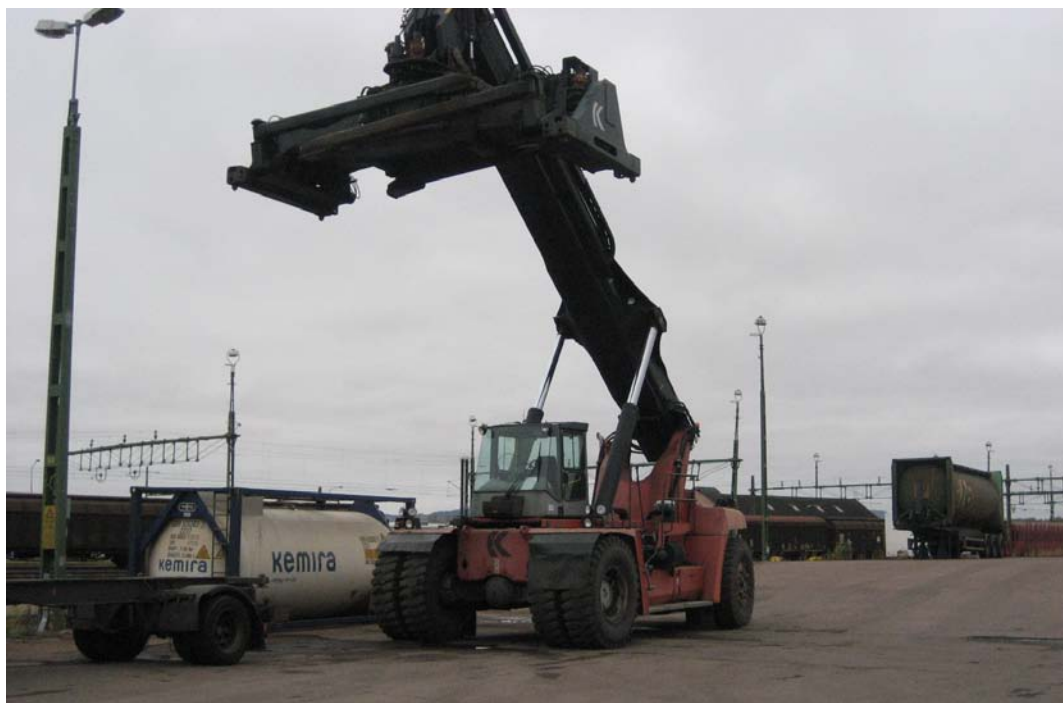
Figur 25 Contchamp med 45 tons lyftkraft som Green Cargo använder vid terminalen i Borlänge.
