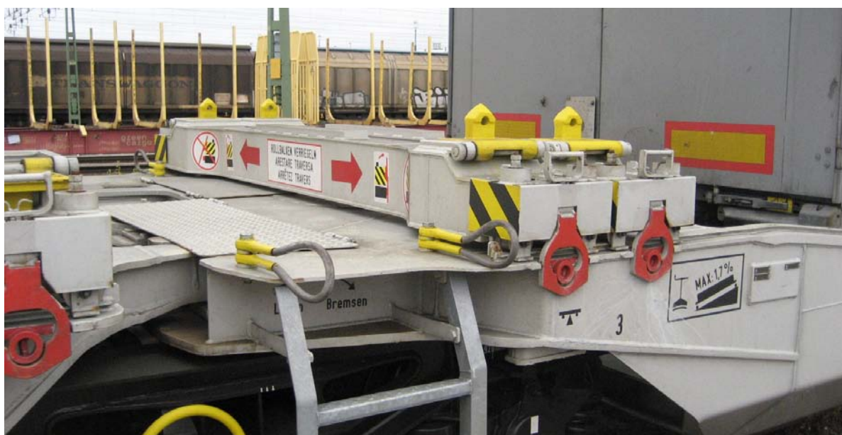
Figur 38 Bredden på vagnarna anpassade för Megatrailers gör att dessa måste utrustas med i längdled justerbara bommar om vagnarna skall användas för transport av ISO-containrar eller växelflak. Två olika varianter har identifierats och ovanstående variant tillverkade av Tatravaggonka Slovakien fanns i Borlänge 2009-12-23 (Foto: Fredrik Bärthel).
