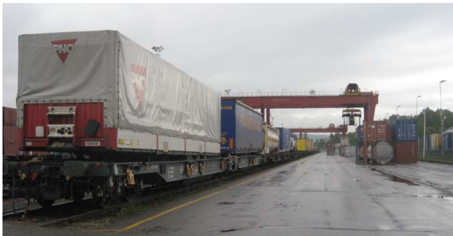
Figur 35 Cargo Net har under 2006/07 genomfört investeringar i 300 vagnar littera Sdggmrs. Till vänster syns en av dessa på terminalen i Alnabru. (Foto: Fredrik Bärthel, 2007-05-24).
