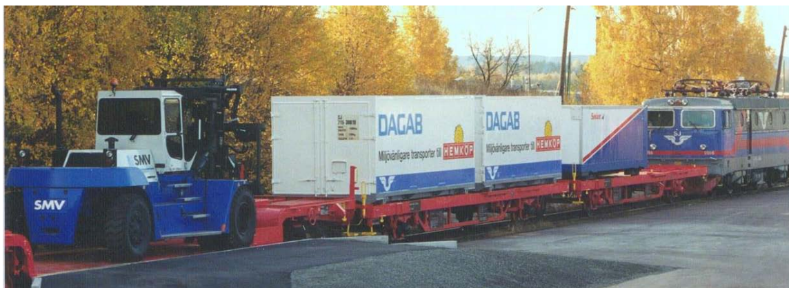
Figur 16 Lättkombitåget i Borlänge 1998. Trucken lastad på en djuplastningsvagn syns till vänster. Rampen som syns framför trucken användes för att köra av trucken från vagnen. (Foto Jan-Ola Wede, Green Cargo).
