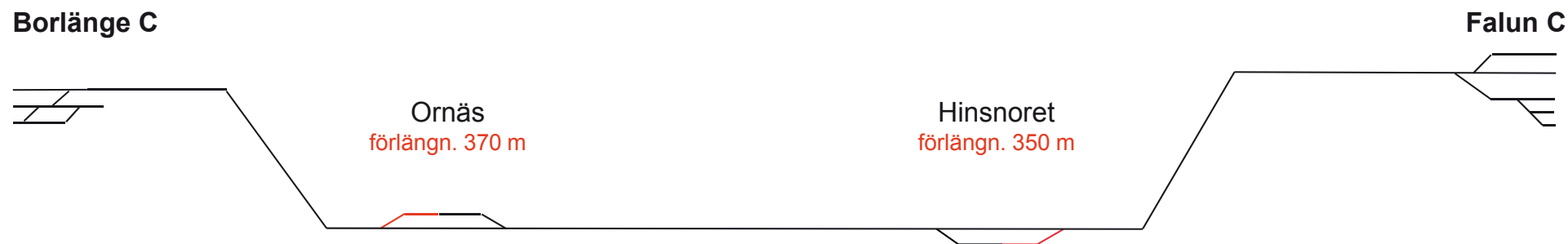
Figur 6.2. Schematisk beskrivning av en utbyggnad enligt sträckningen för UA4 i järnvägsutredningen samt av UA 1 (skissen anger exempel på utbyggnad). Blå markering visar etapp 1 av UA4. För att klara prognostiserad trafik med ett 60 % kapacitetsutnyttjande behövs det längre partiella dubbelspår än järnvägsutredningens enkelspårsalternativ av UA4. Korridoren för UA4 möjliggör även ett komplett dubbelspår mellan Falun och Borlänge.
