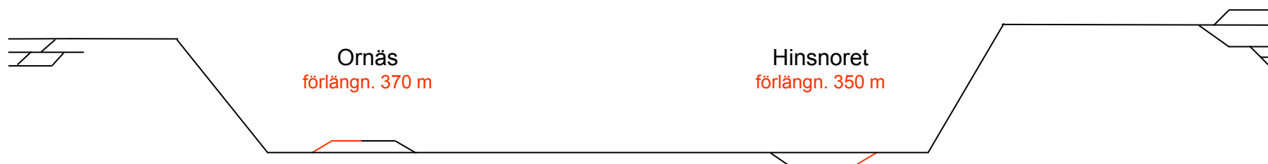
Figur 7.1. Exempel på utbyggnad enligt utredningsalternativ 1 (UA 1). Figuren ska ses som exempel. Förlängning av mötesstationerna kan göras i båda riktningarna.
