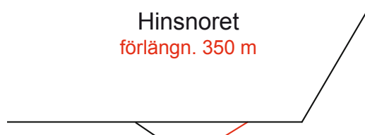
Figur 7.3. Principutformning av Hinsnoret, mötesspåret kan förlängas antingen norrut eller söderut.
