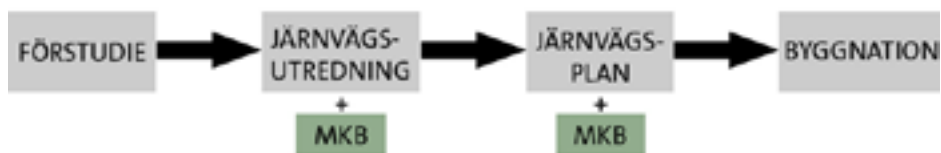
Figur 1.4. Planeringsprocessen vid byggande av järnväg
